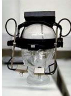
Kuva 3: Päähän kiinnitettävä katseenseurantalaite käytössä, ja kuva laitteesta (Gaze-group).
