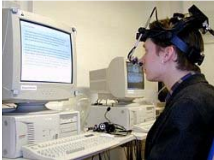
Kuva 3: Päähän kiinnitettävä katseenseurantalaite käytössä, ja kuva laitteesta (Gaze-group).
