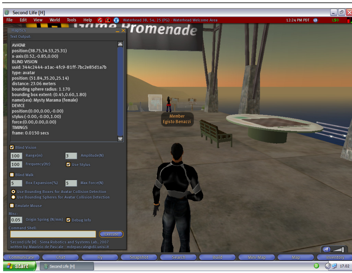
Kuva 3. Kuvankaappaus Second Life-asiakasohjelman muokatusta versiosta. Vasemmalla voidaan nähdä haptiikkaa koskevat asetukset [Pascale et al, 2008].
